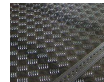
Alu-Riffelboden mit eingelegerter Zurrseile oberflur auf Holzwerkstoff Trägerplatte
