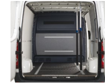
Zurrseilen Boden/ Decke/Seitenwand
